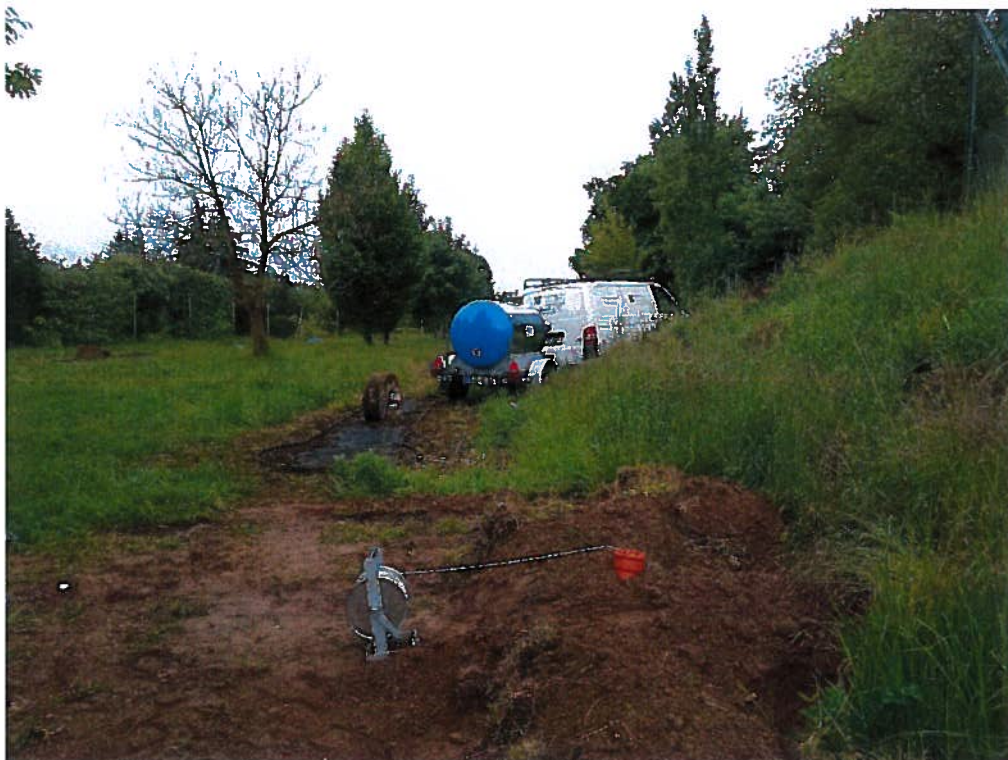
Foto č. 10: Vsakovací zkouška na sondě KS-2
